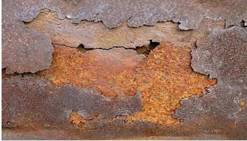
الشكل 27: تآكل الخلية المركزة
